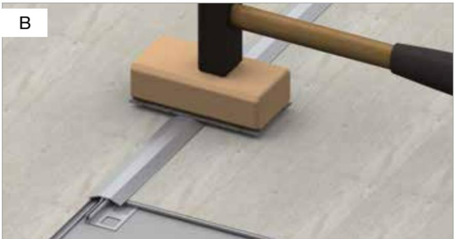
Wenn Sie zwei gleich hohe Vinylböden (Höhe 4–5 mm) verlegen wollen und z. B. im Türbereich einen Übergang haben, können Sie diesen mit einem **clipstech**<sup>®</sup>-mini-Übergangs-Profil überbrücken. Hierzu schrauben oder kleben Sie das Trägerprofil auf den Boden und legen den Vinylboden mit etwa 4 mm Abstand zum Gelenkkopf des Trägerprofils heran. Danach können Sie das Übergangs-Profil aufclipsen. Dies erfolgt mit einem Hammer und einem Holz dazwischen als Schutz gegen Beschädigungen.
