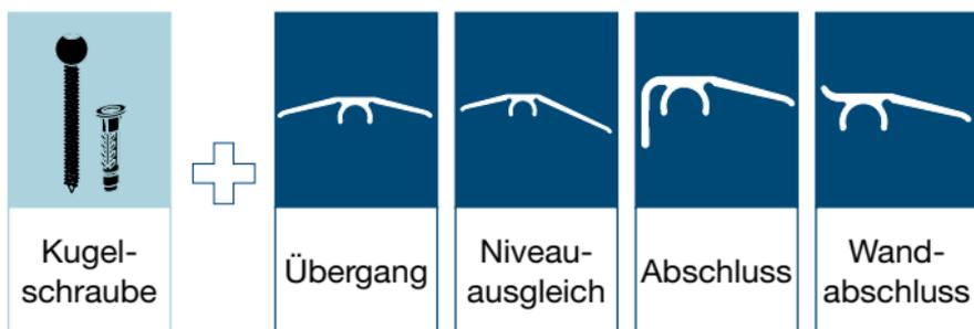
Übergangs-Profil 33 mm, 46 mm und Niveauegleichs-Profil 40 mm, 56 mm, Abschluss-Profil
