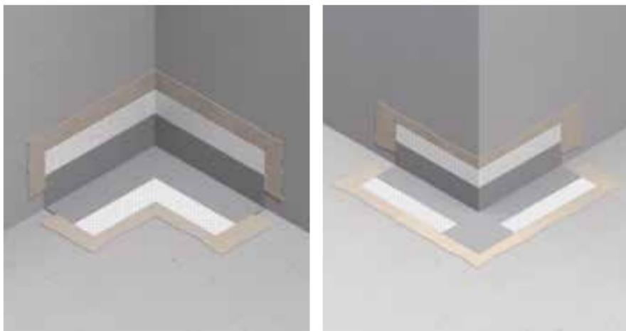
Ergänzungsprodukt zum Profi-Dichtband zur einfachen Abdichtung im Eckbereich. Art.-Nr. 00565 (Innenecke) und Art.-Nr. 00566 (Außenecke)
