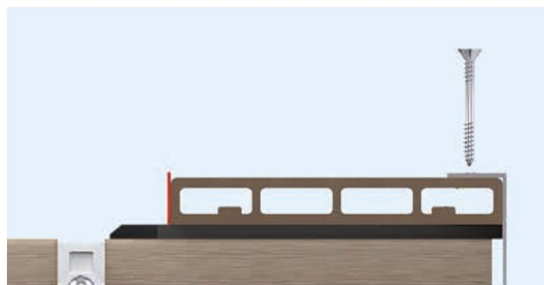
Schrauben Sie die Diele nun durch eines der beiden Löcher im Clip-Ende auf dem Unterkonstruktions-Profil fest.
